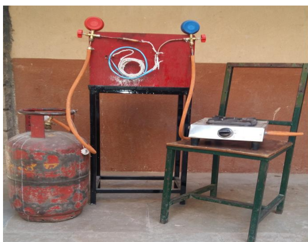
Fig. 4 Actual Setup of LPG Refrigerator
